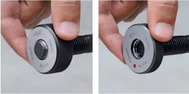
Prüfung mit Präzisions-Gewindelehrring Checking with Precision Thread Ring Gauge
